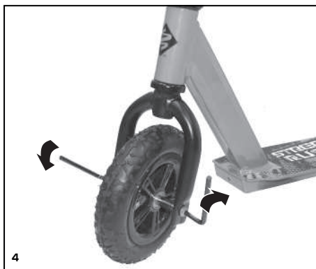
Bezpečne utiahnite maticovú skrutku podľa vyobrazenia.
