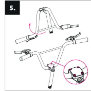
**Instalación Manillar:** coloque el manillar como se muestra en la imagen y apriete los tornillos en la tija.
