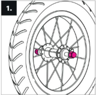
**1. Ensamblaje de la rueda delantera (la mayor):** afloje las dos tuercas.
