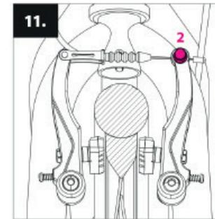
Überprüfen Sie, dass der Abstand der Bremsbeläge von der Felge bei unbetätigtem Bremshebel etwa 1-2mm beträgt. Dieser Abstand lässt sich durch Anziehen oder Lockern des Bremsseils in der Fixierschraube (2) regulieren.
