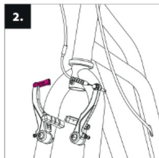
Controllare che la forcella anteriore del monopattino sia girata nel verso giusto (il ceppo del freno a V deve essere rivolto in avanti). Staccare il cavo del freno dal morsetto e allentare il pattino del freno.
