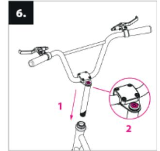
Inserte el manillar en el bastidor delantero (1) y ajuste la altura de acuerdo con las necesidades del ciclista (no superior a la indicada por la línea). Compruebe que el manillar está en posición vertical y ajuste correctamente el tornillo del tubo del manillar (2).
