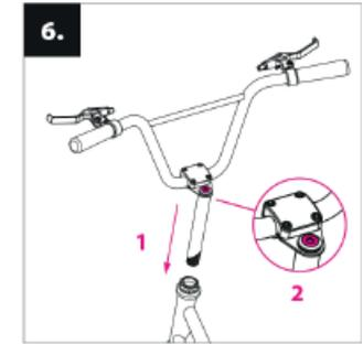
**6.** Schieben Sie die Lenkerstange in das Hauptrohr des Tretrollerrahmens (1) und stellen Sie die gewünschte Höhe des Lenkers ein (bis max. in Höhe des gekennzeichneten Striches). Überprüfen Sie, ob der Lenker gerade ist und ziehen Sie die Inbusschraube der Lenkerstange fest (2).
