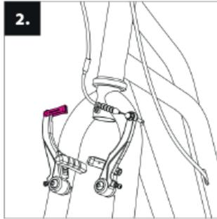
Asegúrese de que la horquilla delantera del scooter está bien posicionada (las palancas de freno deben estar orientados hacia delante). Suelte el cable del freno de su soporte y suelte los brazos del freno.
