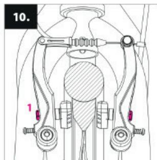
**10.** **Регулировка тормоза:** Нажмите на рычаг тормоза – тормозные колодки должны плотно обхватывать обод с обеих сторон. Если нет, то вы можете настроить их положение с помощью регулировочного болта, который соединяет их с V-образным тормозным рычагом (1). Между колодкой и ободом должен быть просвет 1-2 мм.
