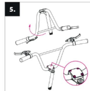
**5. Installation du guidon :** placez le tube du guidon comme sur la photo et resserrez la vis sur la tige.
