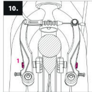
**Ajuste de los frenos:** al frenar, debe controlar que las pastillas de freno de las dos ruedas se adaptan perfectamente a la banda de frenado de la rueda. Si no, usted puede ajustar su posición a través del tornillo que las une a los puentes de freno V-brake (1). Las pastillas no deben tocar el neumático.
