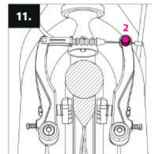
Controllare che dopo il rilascio dei freni i relativi pattini si distanzino a sufficienza dal cerchione (1-2 mm). La distanza dei pattini si può regolare tendendo o allentando il cavo del freno sul perno di fissaggio (2).
