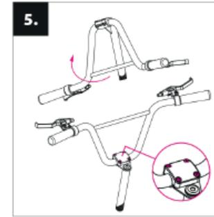
**Stuur montage:** Draai bij het stuur de stuurpen omlaag zoals afgebeeld op de foto en draai de 4 slotbouten van de stuurpen gelijkmatig aan.
