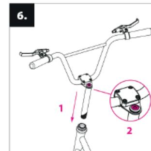
Zasuňte tyč riadenia do hlavovej rúrky rámu kolobežky (1) a nastavte požadovanú výšku riadiel (max. po vyznačenú rysku). Skontrolujte, či sú riadidlá rovno a dotiahnite skrutku na tyči riadenia (2).
