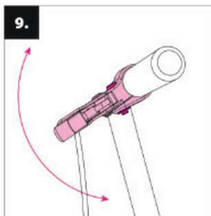
**Seřízení brzdových páček:** nastavte správný sklon brzdových páček pomocí upevňovacího šroubu na objímce.
