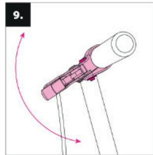
**9. Einstellen der Bremshebel:** stellen Sie die richtige Lage der Bremshebel am Lenker mit Hilfe der Klemmschraube des Bremshebelhalters ein.
