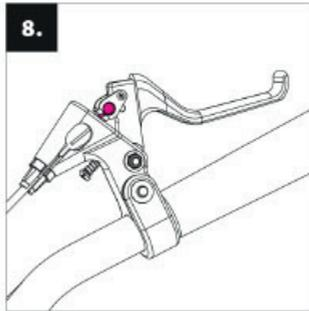
**La instalación de los cables de freno:** presione la palanca del freno al máximo y coloque el final del cable de freno en el punto de fijación circular. Repita la acción con los dos frenos.
