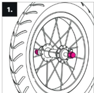
**1.** Возьмите переднее колесо. Открутите обе гайки.
