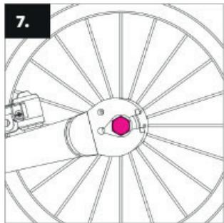
**7. Die Montage des hinteren Rades erfolgt ident zum Vorderrad:** Die Radmuttern lockern, das Bremsseil aushängen und die Bremsarme öffnen. Einbau des Rades in die Hinterradgabel, auf zentrischen Sitz achten, Radmuttern festziehen und das Bremsseil in den Bremsenzug einhängen.
