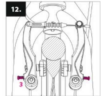
Als het wiel niet vrij kan draaien en "afremt" aan een kant, kan dit bijgesteld worden door het aandraaien van de stelschroef op de arm van de V-brake die het wiel "afremt" **(3)**.
