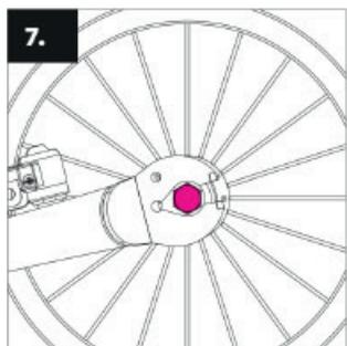
**Montera bakhjulet** på samma sätt som framhjulet. Lossa muttrarna, frigör bromswire från hållaren och lossa bromsarmarna. Placera sedan bakhjulet i ramens bakhjuls-fäste så det blir ordentligt centrerat, skruva åt båda muttrarna och sätt tillbaka bromswiren i hållaren.
