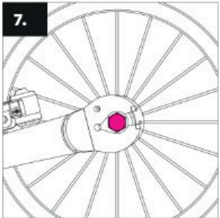
**Ensamble de la rueda trasera,** no difiere del ensamblaje de la rueda delantera. Afloje las dos tuercas, suelte el cable del freno de su soporte y suelte los brazos del freno. A continuación, coloque la rueda en la parte trasera de la horquilla asegurándose que esté bien centrada, apriete las tuercas y coloque el cable del freno en el soporte.
