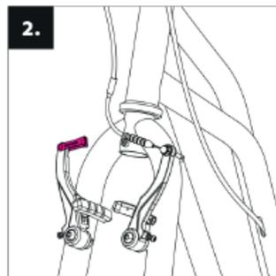
Skontrolujte, či je predná vidlica kolobežky natočená v správnom smere (ramená V-brzdy smerujú dopredu). Uvoľnite brzdové lanko z vodítka a uvoľnite brzdové ramená.
