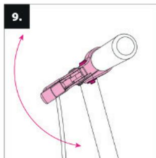
**9. Ajustement des leviers de frein :** incliner le levier de frein correctement en desserrant la vis sur le manche.
