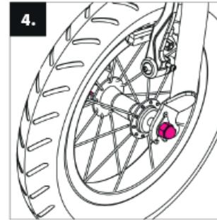
**4.** Ziehen Sie beide Radmuttern zunächst leicht an und dann fest. Hängen Sie das Bremsseil wieder in den Bremsenzug ein.
