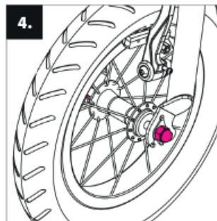
**4.** Затяните обе гайки. Поместите тормозной трос в держатель тормозного рычага.
