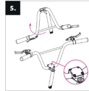
**5. Anbringen der Lenkerstange:** Positionieren Sie die Lenkerstange gemäß der Abbildung und ziehen Sie die Schrauben des Lenkstangenvorbaus an.
