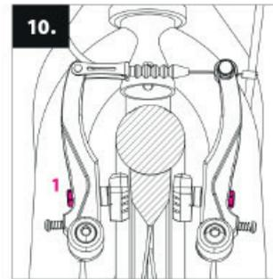
**10. Einstellung der Bremse:** überprüfen Sie auf beiden Rädern, dass die Bremsbeläge beim Bremsen mit ihrer ganzen Fläche auf der Seitenwand der Felge aufliegen. Falls nicht, lösen Sie die Feststellschraube der Bremsklötze und positionieren diese. Nach dem Festziehen der Schraube sind die Bremsklötze zu den Armen der V-Bremse (1) fixiert. ACHTUNG! Die Klötze dürfen nie den Mantel des Reifens berühren.
