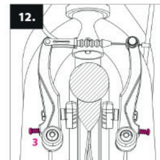
**12.** Si le pad touche la roue quand vous roulez, ajustement symétriquement la distance des bras de freins en resserrant les vis (3).
