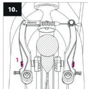
**10. Ajustement des freins :** quand vous freinez, vérifiez que les pad de frein des 2 roues viennent serrer la jante des 2 cotés. Si ce n'est pas le cas, vous pouvez ajuster leur position via une vis qui les relie au bras du V-brake (1). Le pad ne doit absolument pas toucher le pneu.
