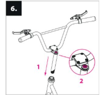
Schuif het stuur respectievelijk de stuurstang in de balhoofdbuis **(1)** stel de hoogte van het stuur in vanaf de grond volgens de behoefte van de gebruiker, waarbij de maximale uitschuifmogelijkheid gemarkeerd is op de stuurpen. Controleer of het stuur recht staat ten opzichte van het voorwiel en draai de bout op de stuurpen goed aan **(2)**.
