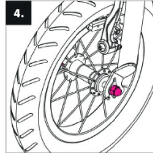
Apretar las dos tuercas y coloque el cable del freno en el soporte.
