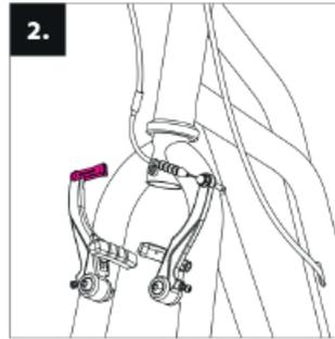
Bringen Sie die Vordergabel des Tretrollers so in Position, dass die Arme der V-Bremse nach vorne gerichtet sind. Hängen Sie das Bremsseil aus der Gegenzugseite aus und öffnen Sie die Bremsarme.
