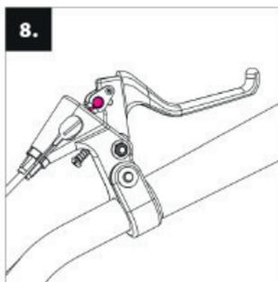
**Instalace brzdových lanek:** zmáčkněte brzdovou páčku na maximum a do kulatého oka vložte konec brzdového lanka. Stejný postup zopakujte na obou páčkách.
