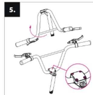
**Installation av styre:** Placera styrröret som visas på bilden och dra åt skruvarna på ramen.
