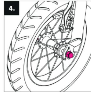
Draai beide moeren goed aan en breng de remkabel terug in de houder.
