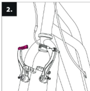
Kontrollera att framgaffeln på sparkcykeln är i rätt position (bromshandtag är vända framåt). Lossa bromsvajern från hållaren på bromsarmarna.
