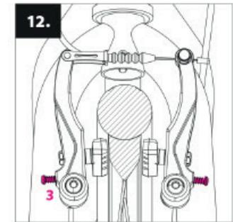
Falls der Reifen beim drehen an irgendeiner Stelle den Bremsbelag streift, stellen Sie die Entfernung der Bremsarme durch die Spannschrauben (3) symmetrisch ein.
