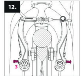
En el caso de la pastilla de freno esté en contacto con la rueda al girar, se debe ajustar simétricamente ajustando la distancia de los brazos del puente de freno con los tornillos de apriete (3).
