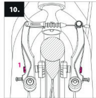
**Afstellen van de remmen:** Druk de beide remarmen van de V-brake in de richting van de velg van het wiel en stel met de juiste sleutel de remblokken zo af dat ze bij het remmen met hun hele remoppervlak tegen de zijkant van de velg wrijven **(1)**. De remschoen (remblok) hoort de band niet te raken.
