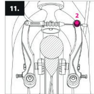
Compruebe que las pastillas disponen de suficiente espacio (1 a 2 mm) después de soltar las palancas de freno. La distancia se puede ajustar apretando o aflojando el cable de freno en el tornillo de anclaje (2).
