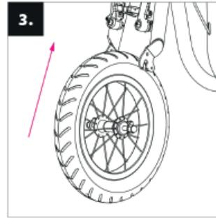
**3.** Führen Sie die Radachse von unten in die Schlitz der vorderen Gabel, und positionieren Sie das Rad so, dass es genau in der Mitte ist.
