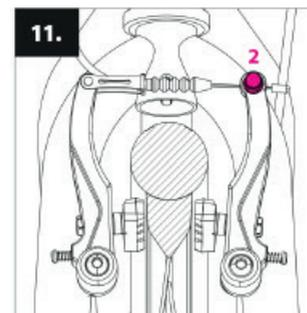
**11.** Отпустите рычаг тормоза. Прокрутите колесо несколько раз. Убедитесь, что оно не задевает за тормозные колодки. Между колодками и ободом должен быть просвет 1-2 мм. Расстояние можно регулировать путем затягивания или ослабления винта на тормозном тросе (2).
