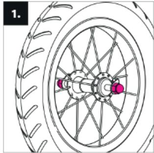
**1. Montage des vorderen Rades:** Lockern Sie beide Radmuttern.
